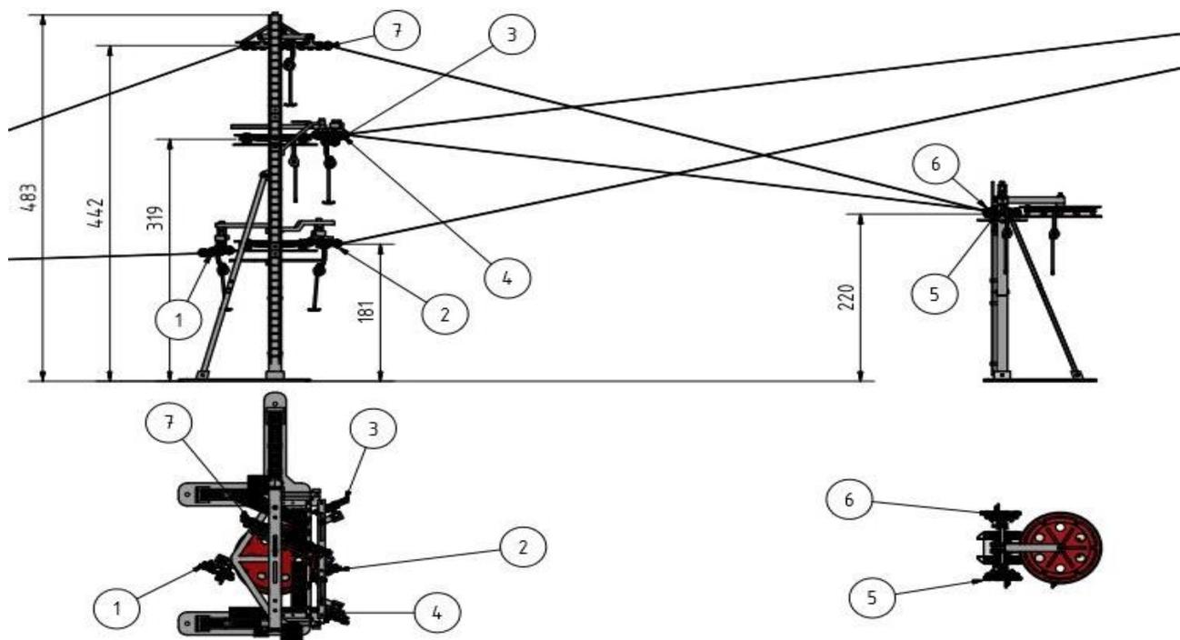
Aus platztechnischen Gründen können bei den Rollenbatterien 1,2,3,4,5 und 6 nur 2er, 4er oder 4er Wechsellast Rollenbatterien verwendet werden.
